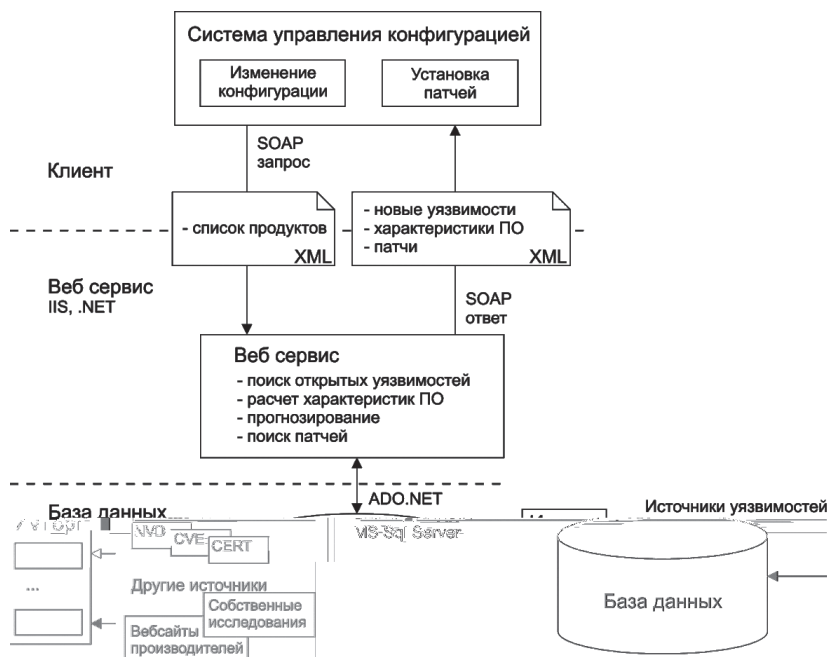
Рис. 3. Архитектура разработанного веб-сервиса
