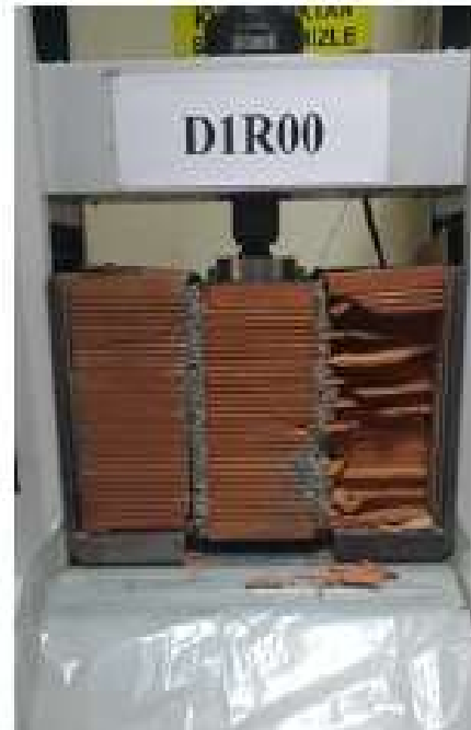
Fig. 2.20: Failure of URT (Berna and Erkan, 2017)
